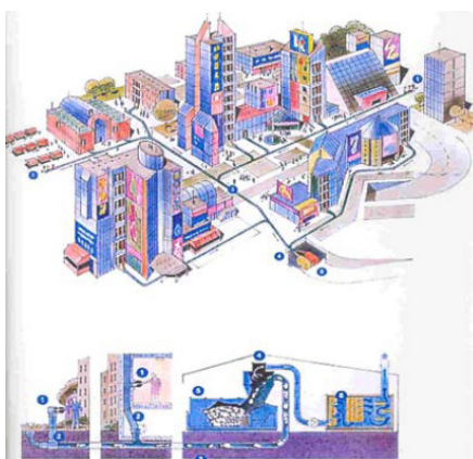
Fig.5. Schema di RT pneum con centrale fissa
