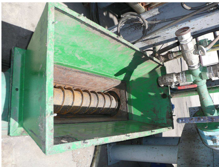
Fig. 42: Pompa Novarotors – particolare tramoggia di carico
