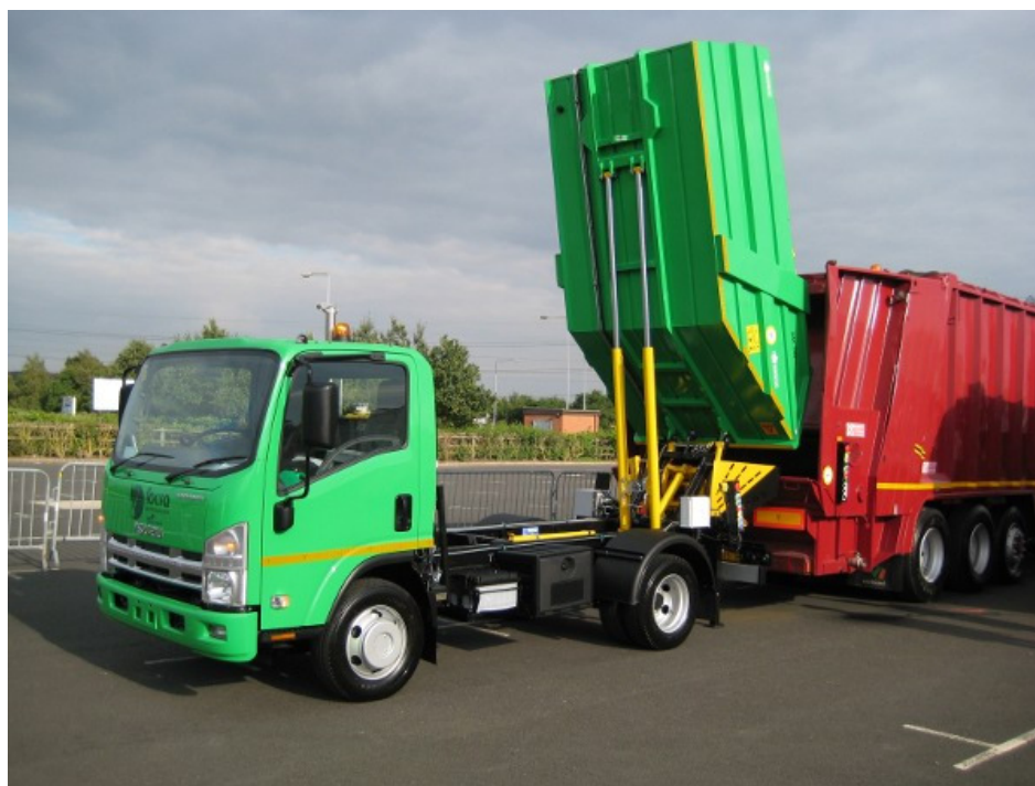
Figura 4 - Esempio di trasbordo da veicolo a vasca con costipatore (7,00m 3 ) ad un compacttore di capacità media o grande (25,00 ÷ 30,00 m 3 )
