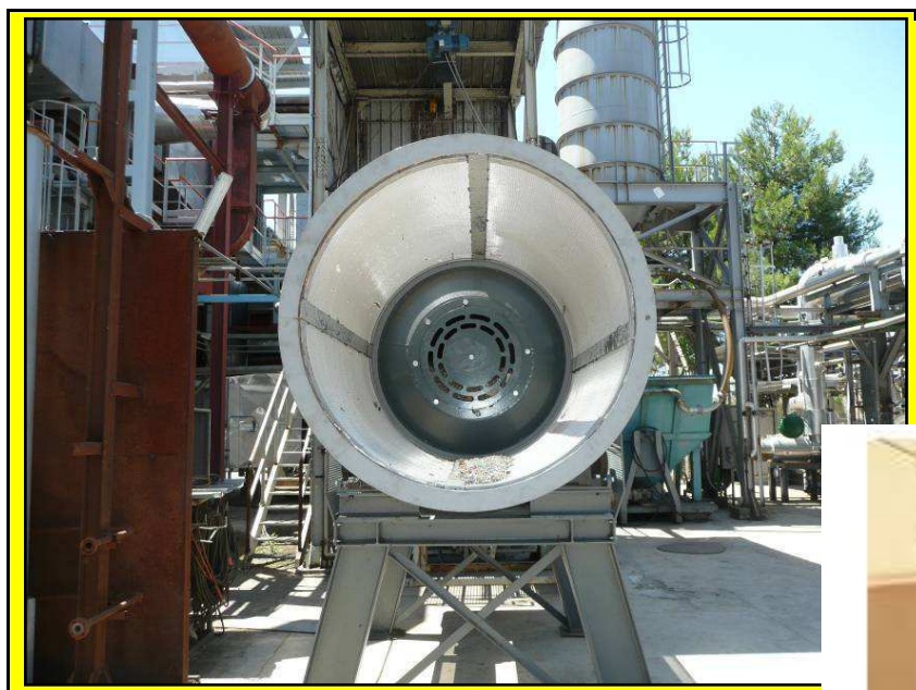
Fig. 39: Mulino a barre – vista d'insieme
