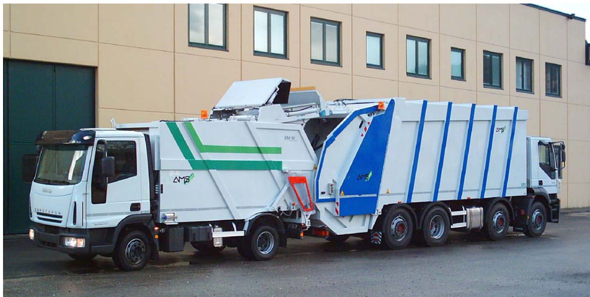
Figura 3 – Esempio di trasbordo da un minicompattatore (7,00m 3 ) ad un compacttore di capacità media o grande (25,00 ÷ 30,00 m 3 )
