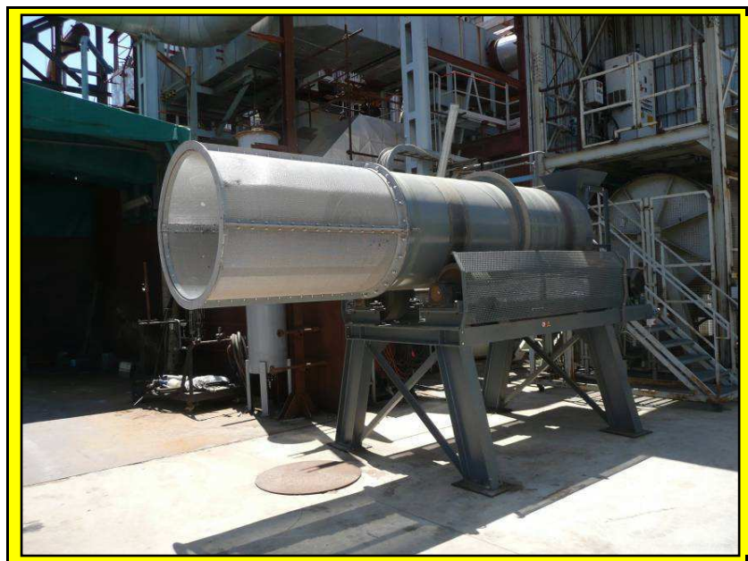
Fig. 38: Mulino a barre – vista d'insieme
