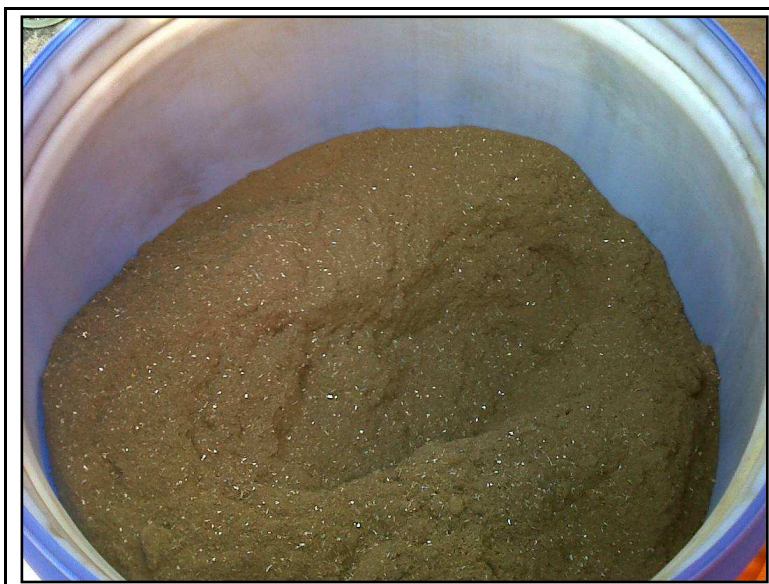
Fig. 43: Materiale pulverulento sottovaglio mulino a barre
