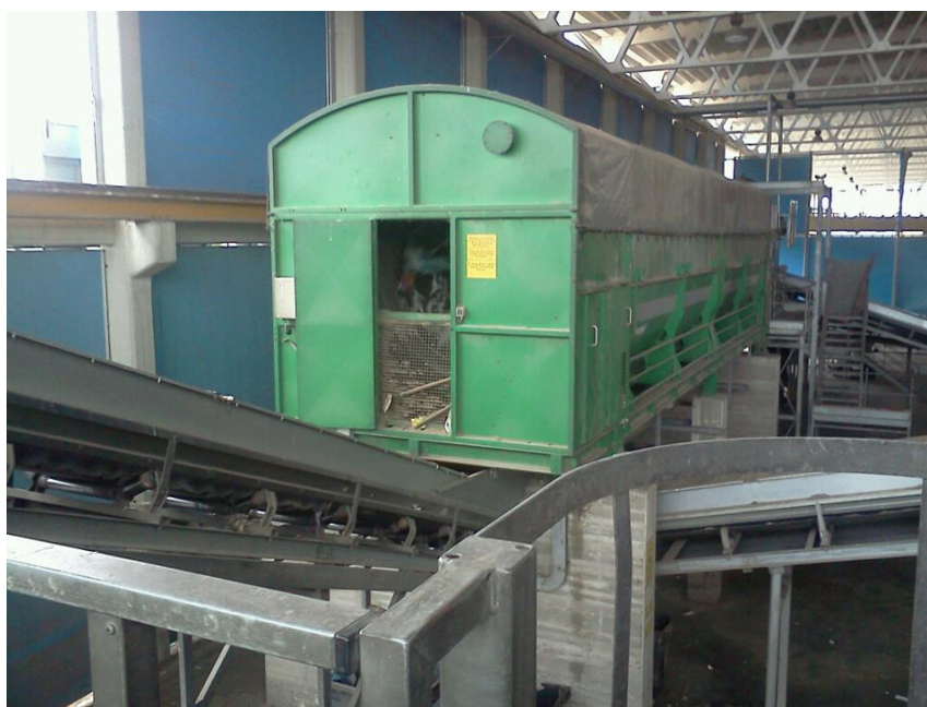
Foto 13. Selezione granulometrica a 80 mm del rifiuto biostabilizzato – Foto area del vaglio da cui si dipartono i nastri del sottovaglio (RBD) e del sopravaglio (FSC) -Foto scattata presso Amiu Spa-Bari
