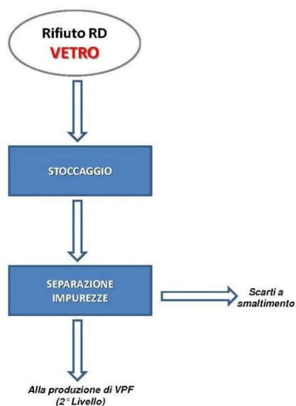
Figura 26. 1° LIVELLO FILIERA VETRO: Schema tipo impianto di selezione impurezze e stoccaggio vetro da RD monomateriale
