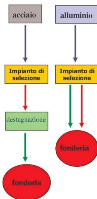
Figura 29. 1° e 2° LIVELLO FILIERA METALLI. Selezione impurezze, separazione eventuale da flusso plastiche e successivo recupero in fonderia (previa de stagnazione per l'acciaio)
