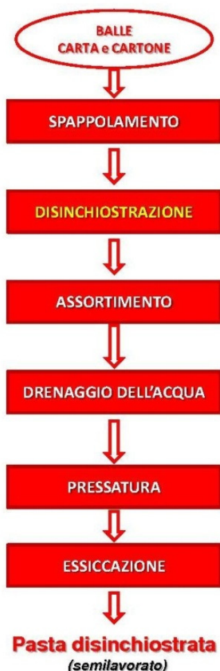
Figura 25. 2° LIVELLO FILIERA CARTA E CARTONE: Schema tipo impianto di produzione pasta di carta. Investimento stimato: 6 ÷ 8 M€ per una potenzialità di 40.000 t/a.
