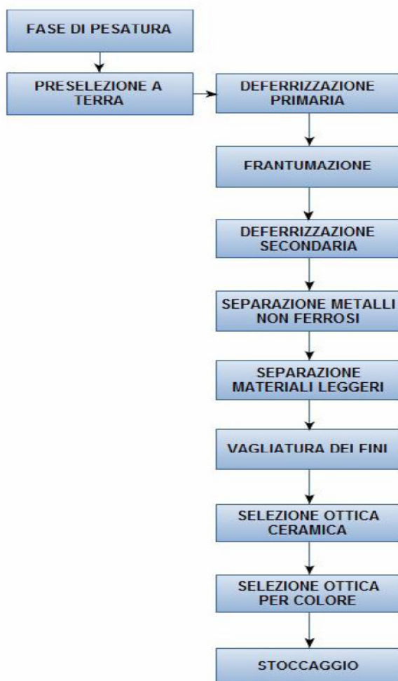
Figura 27. 2° LIVELLO FILIERA VETRO: Schema tipo semplificato di un impianto di produzione Vetro Pronto al Forno - Investimento stimato: ca. 15 M€ (Potenzialità ca. 120.000 t/a)
