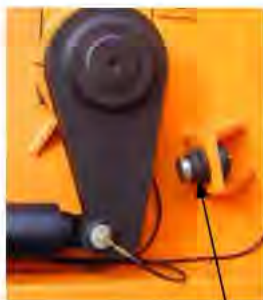
Perno regolazione apertura max pettine
