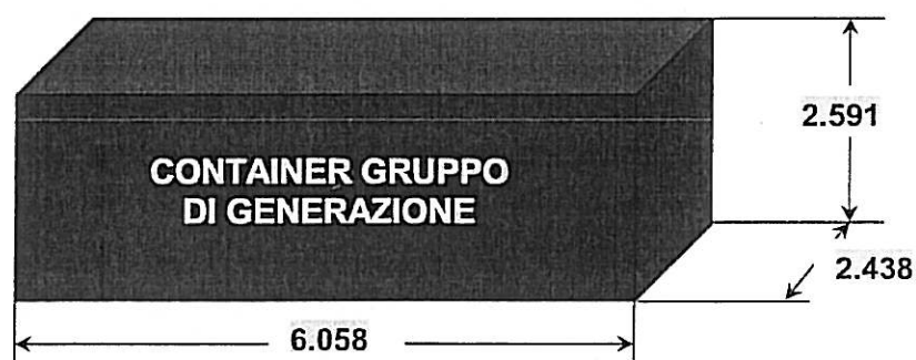
DISEGNO 6-4: INGOMBRI ESTERNI DELLA MACCHINA E DEL CONTAINER PER AL VERSIONE GF4000
