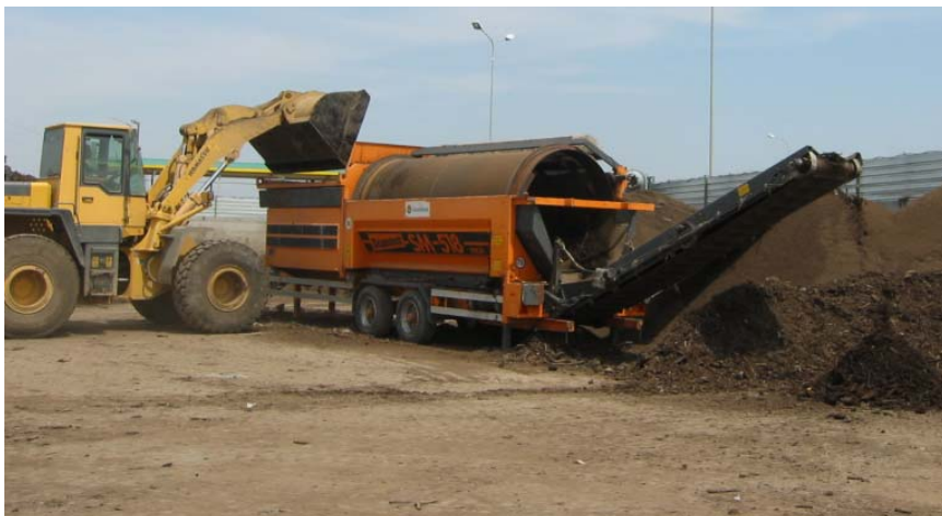
Figura 3 Vaglio a tamburo rotante (tipico)
