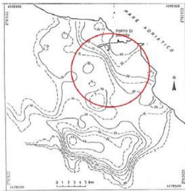
Figura 19: Curve Isopache dei depositi argillosi impermeabili.
