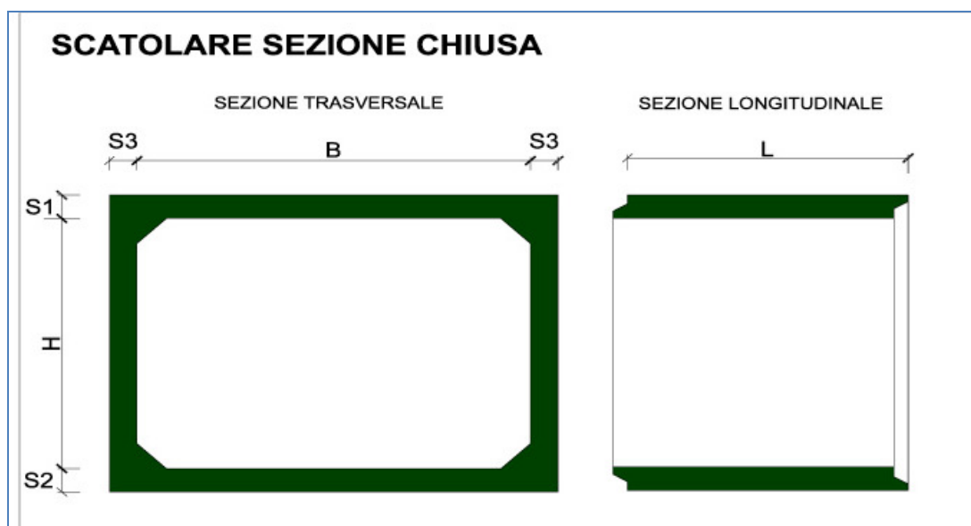
Figura 3.3. Sezione tipo dello scatolare in c.a.
