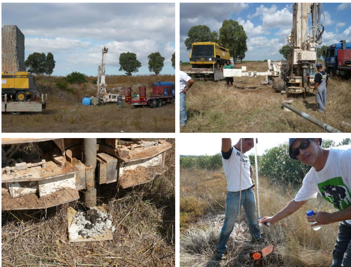
Figura 3. Fotografie relative alle procedure di carotaggio e di campionamento statico dei piezometri.
