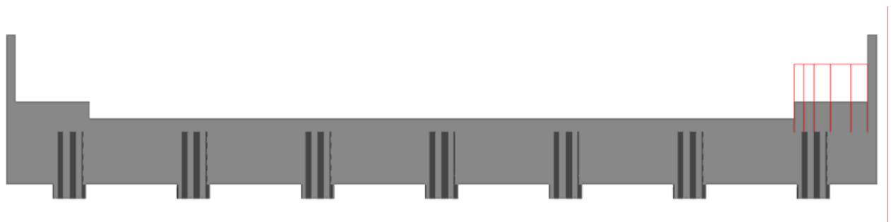
Disposizione nella direzione trasversale dei carichi q_{fk}
